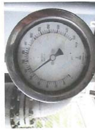
รูปมาตรวัดแรงดันก่อนเข้าอุปกรณ์รับลดแรงดัน
